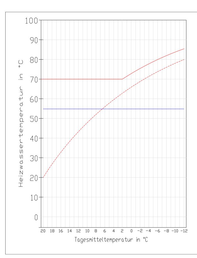
Vorlauftemperatur des Fernwärme-Netzes
